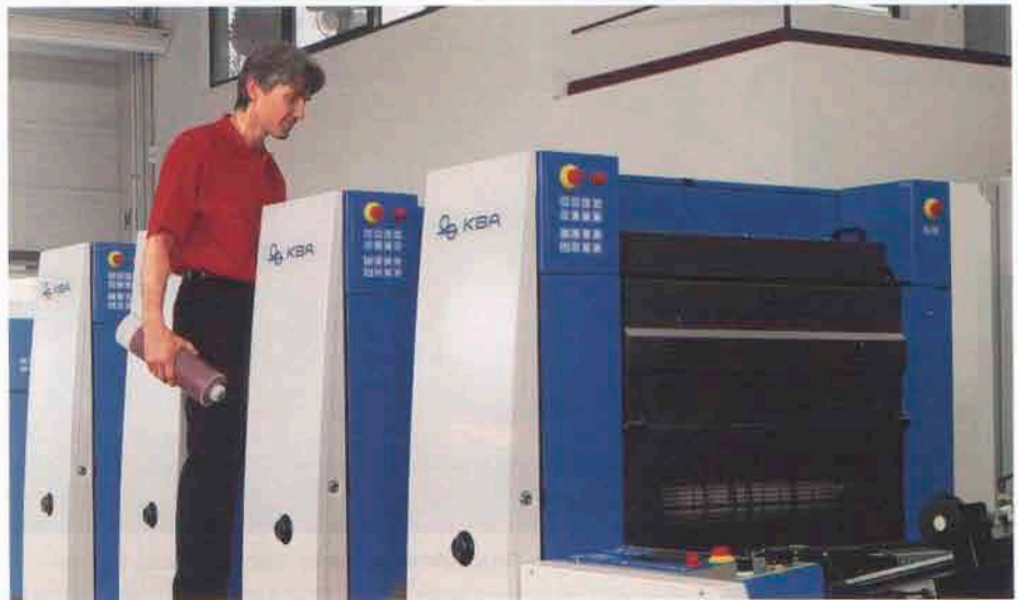
2. Preis: Bogenoffsetmaschine KBA Rapida 74 G mit zonen-schraubenlosen Kurzfarbwerken.
